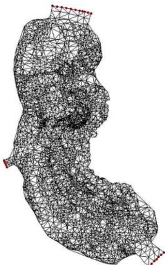
Рис. 6.15. Конечно-элементная сетка поймы р. Ипуть (9047 элементов и 18252 узлов).
