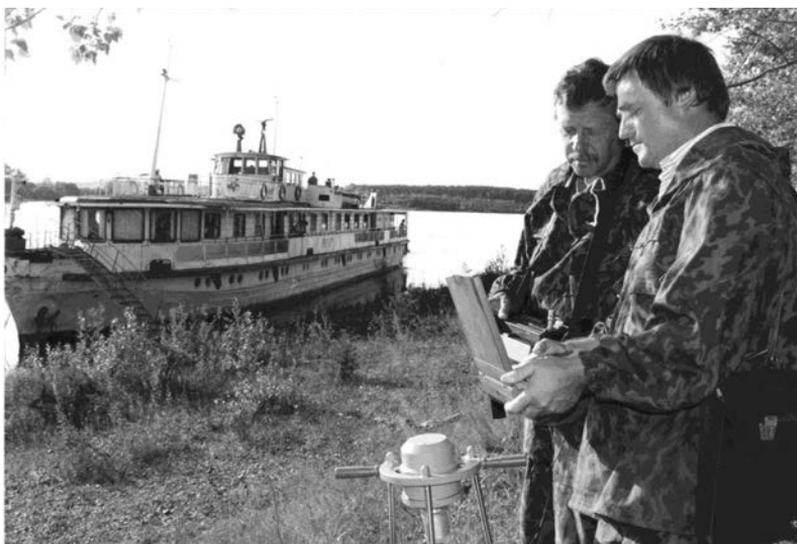
Рис. 5.19. Проведение  $\gamma$ -спектрометрической съемки с помощью портативного гамма-спектрометра с коллимированным детектором «КОРАД» на р. Енисей.
