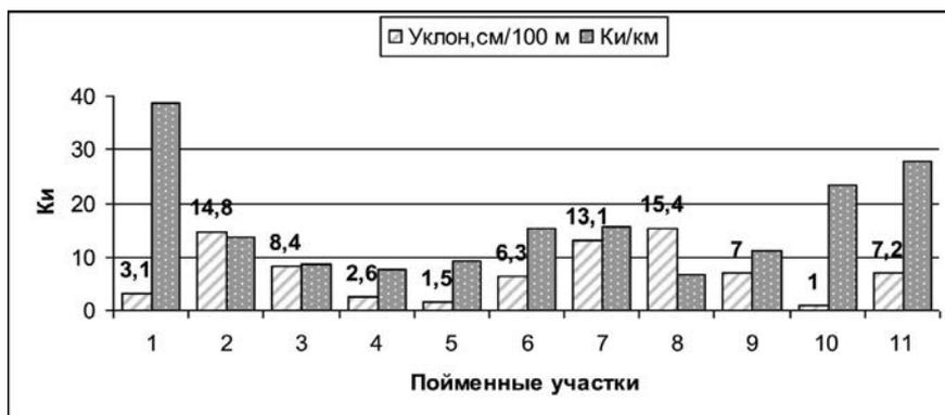
Рис. 5.13. Нормированное на единицу длины русла распределение  $^{137}\text{Cs}$  в пойме р. Теча в районе д. Муслюмово в зависимости от уклона русла.
