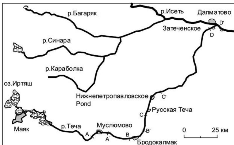
Рис. 5.6. Схема радиометрической съемки на р. Теча. А-А', В-В', С-С', D-D' – участки съемки (Говорун и др., 2000).
