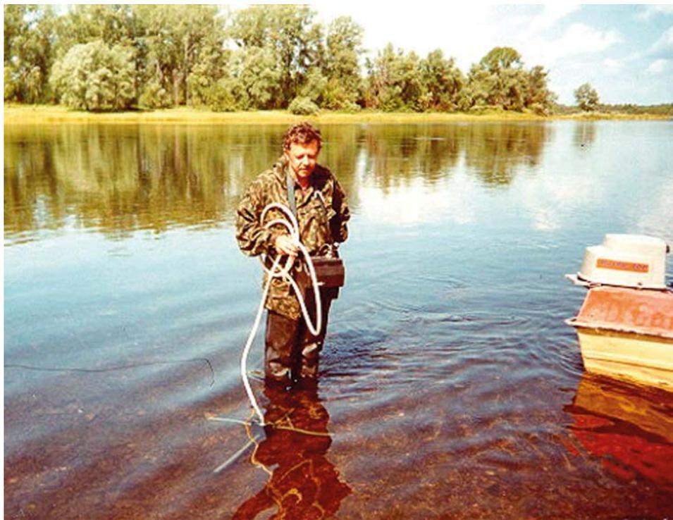
Рис. 2.6. Проведение измерения загрязнения техногенными радионуклидами донных отложений на р. Енисей (Балчуговская протока, 2000 г.).
