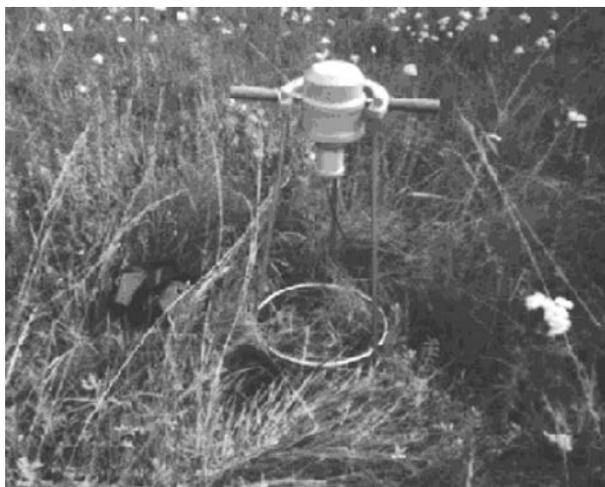
Рис. 2.1. Измерение плотности загрязнения техногенными радионуклидами радиометром РКГ-09Н «КОРАД» в полевых условиях.
